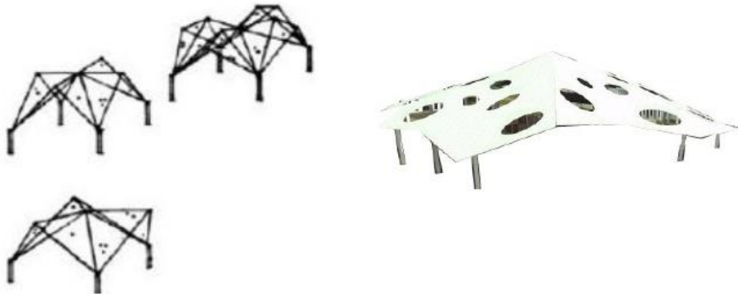
Figura 6. Sistema de Plegaduras Interseccionadas
