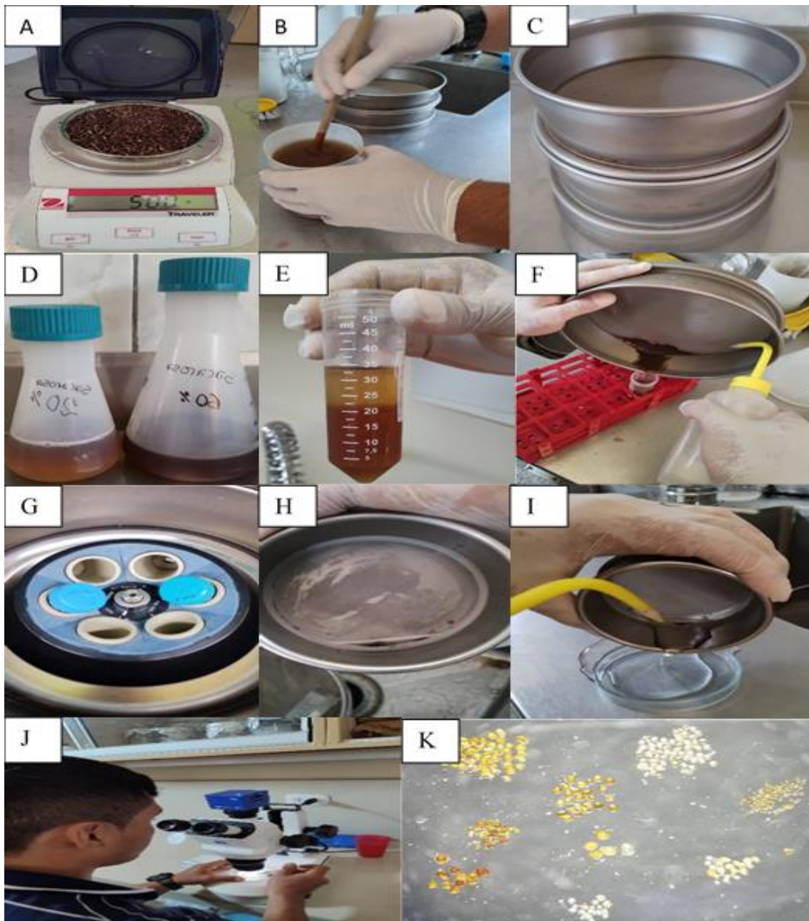
Figura 3. Proceso de extracción y aislamiento de esporas de HMA de suelos de campo tanto agrícola como bosque A: Pesado de 50 g de suelo, B: Suspensión de muestra de suelo en agua, C: Serie de tamices ( 38, 250 \mu m) utilizados para el aislamiento de esporas, D: Sacarosa de 20 y 60%, E: Gradiente sacarosa de 20 y 60%, F: Sobrenadante en tubo falcón de 45ml, G: Centrifugado a 3500rpm por 5min, H: Vaciado del sobrenadante al tamiz de 38 \mu m, I: Vaciado del sobrenadante en la Placa Petri, J: Aislamiento y separación de esporas, K: Separación de esporas por morfotipos.
