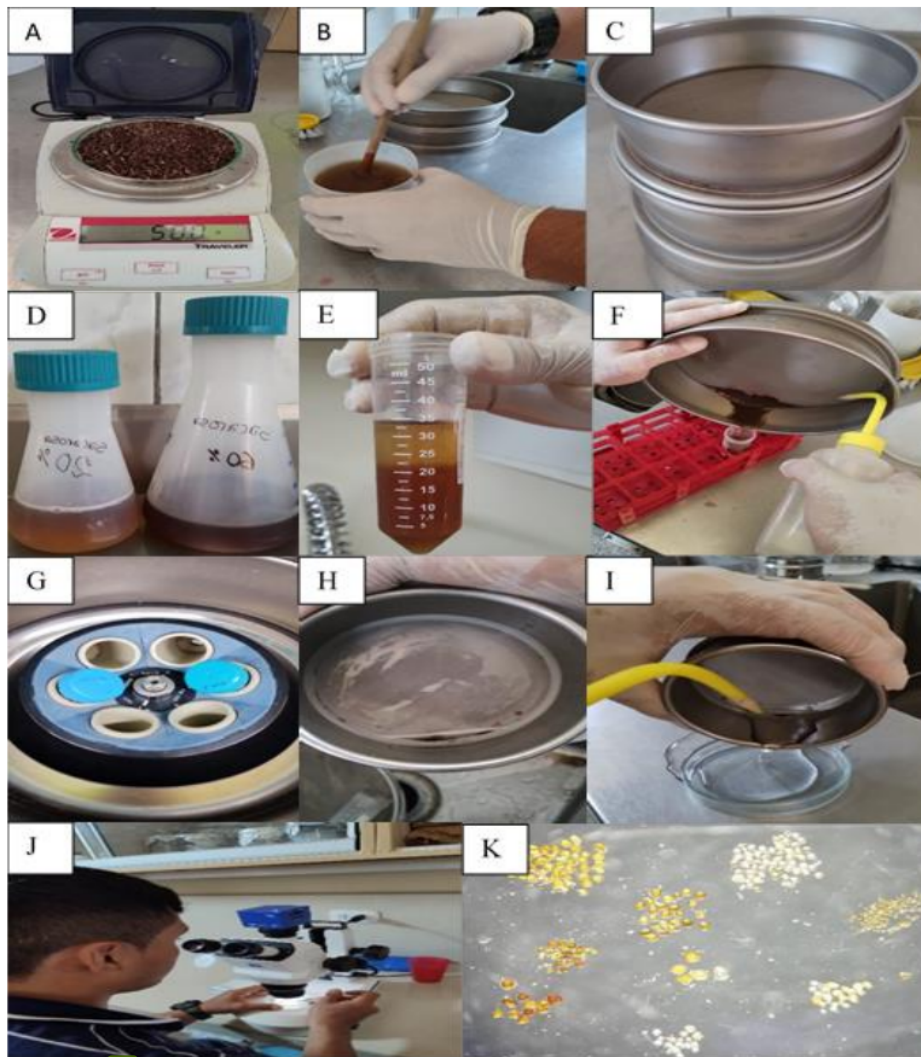
Figura 3. Proceso de extracción y aislamiento de esporas de HMA de suelos de campo tanto agrícola como bosque A: Pesado de 50 g de suelo, B: Suspensión de muestra de suelo en agua, C: Serie de tamices ( 38, 250 \mu\text{m} ) utilizados para el aislamiento de esporas, D: Sacarosa de 20 y 60%, E: Gradiente sacarosa de 20 y 60%, F: Sobrenadante en tubo falcón de 45ml, G: Centrifugado a 3500rpm por 5min, H: Vaciado del sobrenadante al tamiz de 38 \mu\text{m} , I: Vaciado del sobrenadante en la Placa Petri, J: Aislamiento y separación de esporas, K: Separación de esporas por morfotipos.
