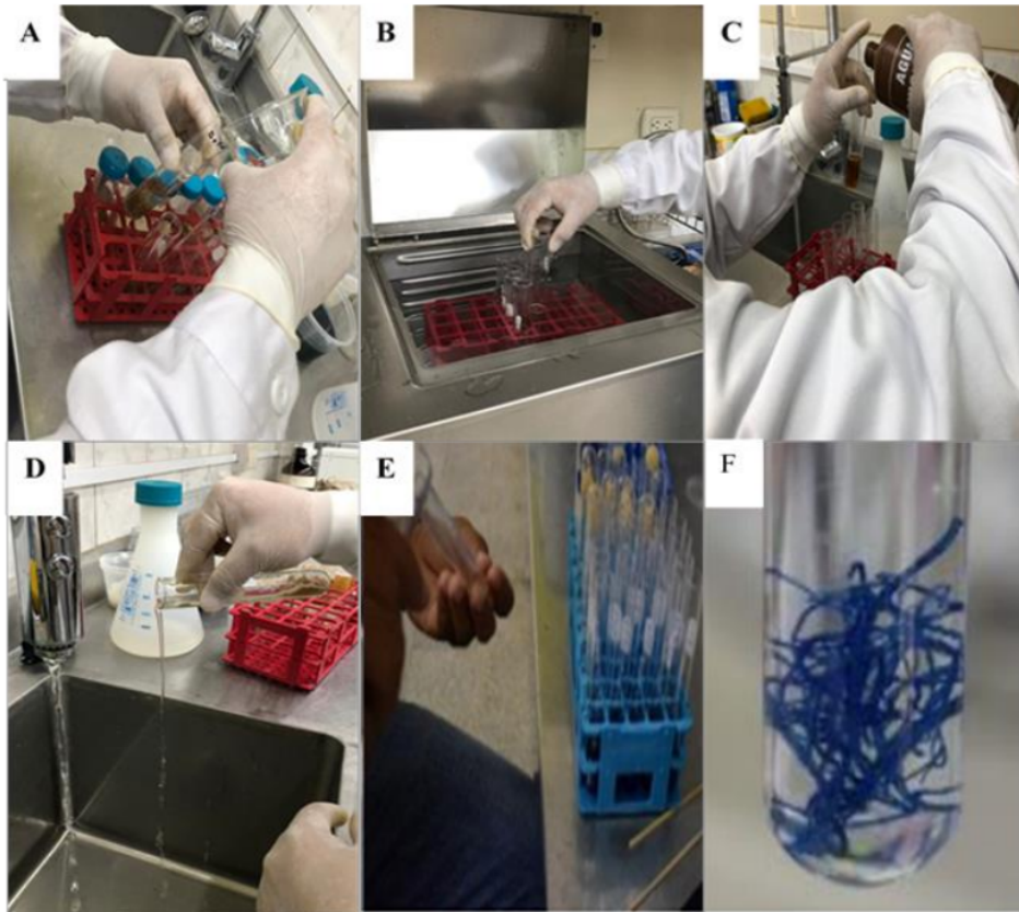
Figura 5. Proceso de tinción de raíces tanto para café y bosque, A: Adición de KOH (10%) a tubos de ensayo conteniendo las raíces, B: Colocado de muestras en baño maría a 90 °C, C: Adición de agua oxigenada de 20 volúmenes, D: Enjuague y lavado con agua corriente, E: Reposo para eliminar el contenido líquido, F: Adición de tinta Parker Quink 5,7% a las raíces.
