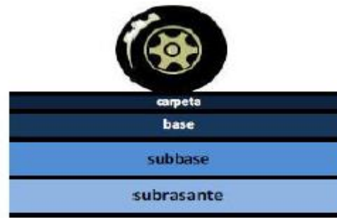
Figura 1. Estructura del pavimento flexible.
