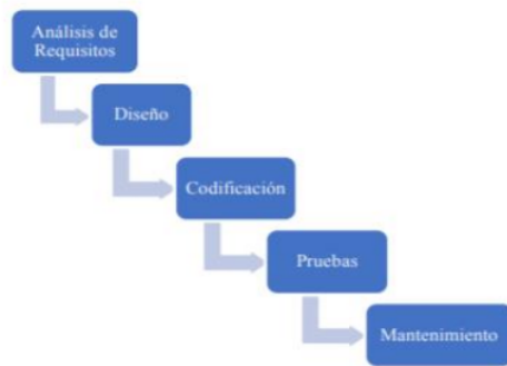
Figura 1. Fases del modelo en cascada. Fuente: Tomado de Montero Molina et al. (2018)
