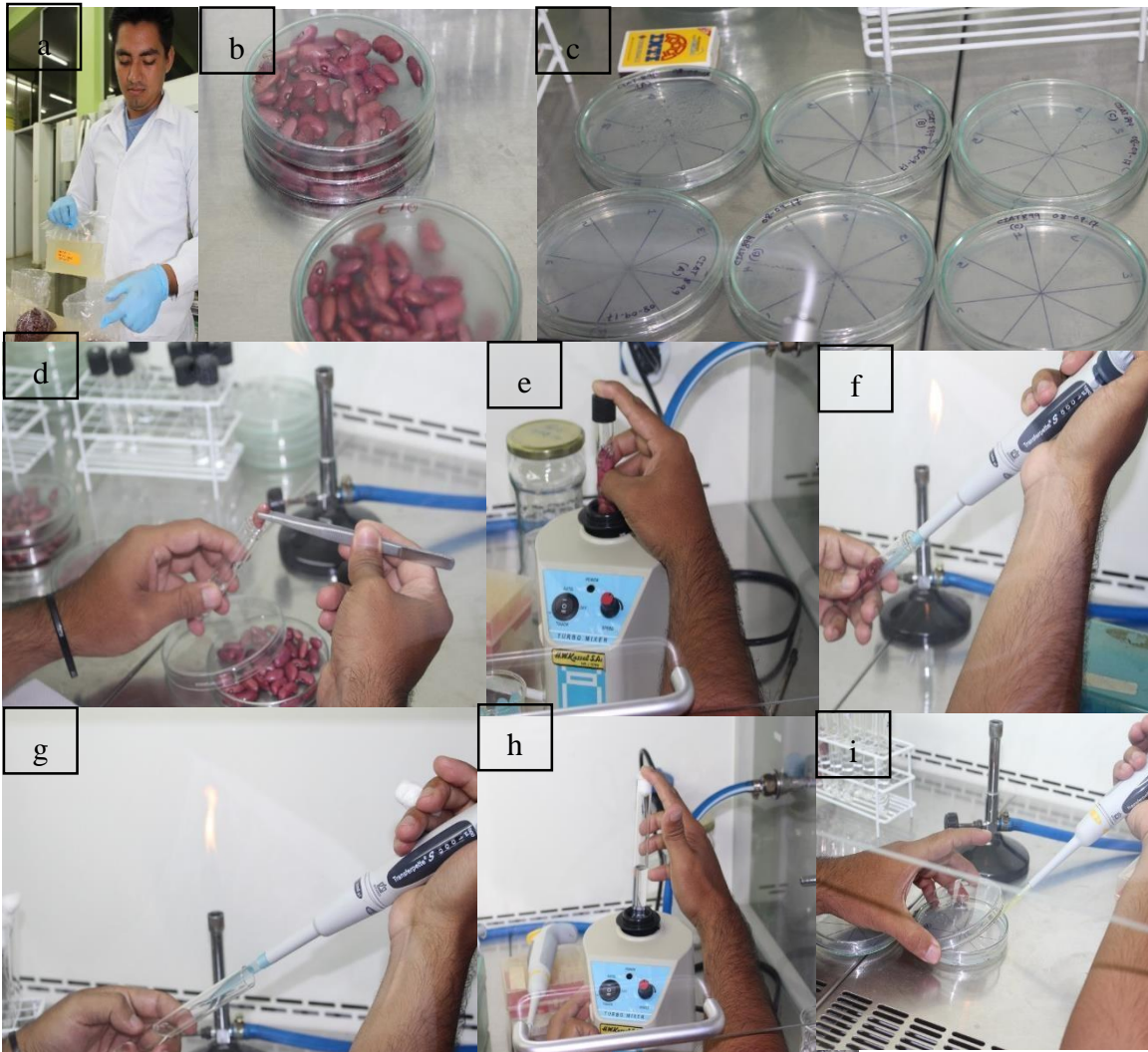
Figura 13. Proceso de comprobación de la supervivencia de Rizobium en las semillas de Panamito inoculadas. a) Inoculación de semillas con Rizobium b) 15 semillas extraídas para las pruebas de comprobación c) Placas Petri con medio YEM para la evaluación de población bacteriana, d) e) y f) Extracción de inoculante g) y h) Agitación de medio YEM inoculado i) Siembra de inoculante en placas.
