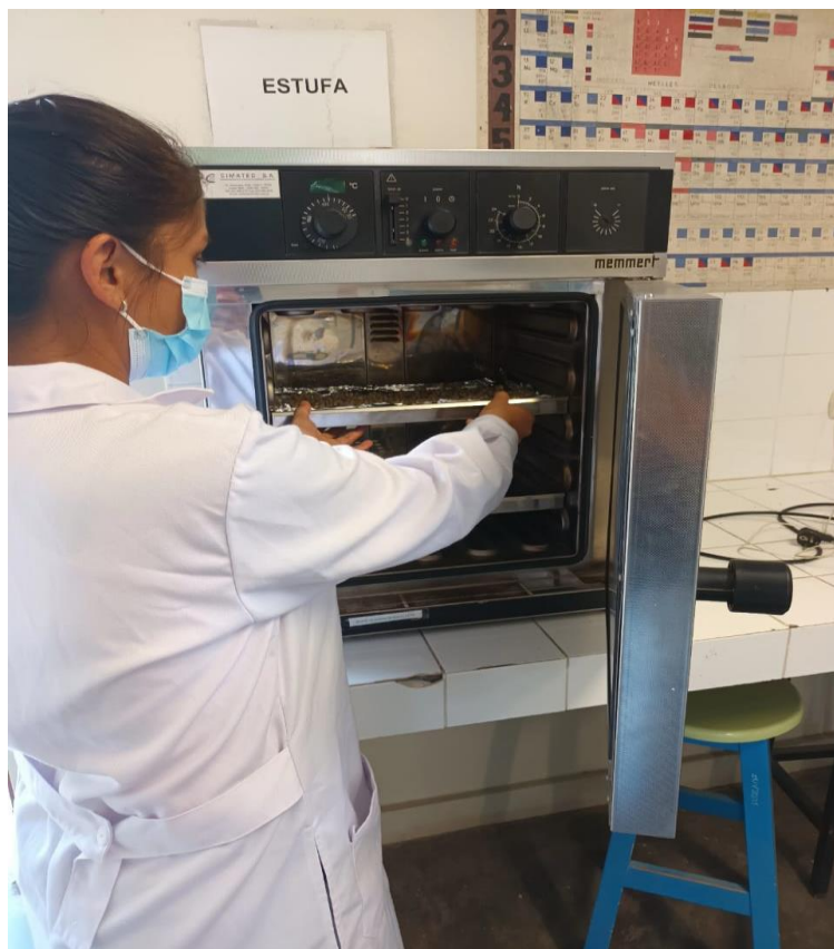
Fotografía 13. Secado del polvo después de la extracción de aceites y grasas.
