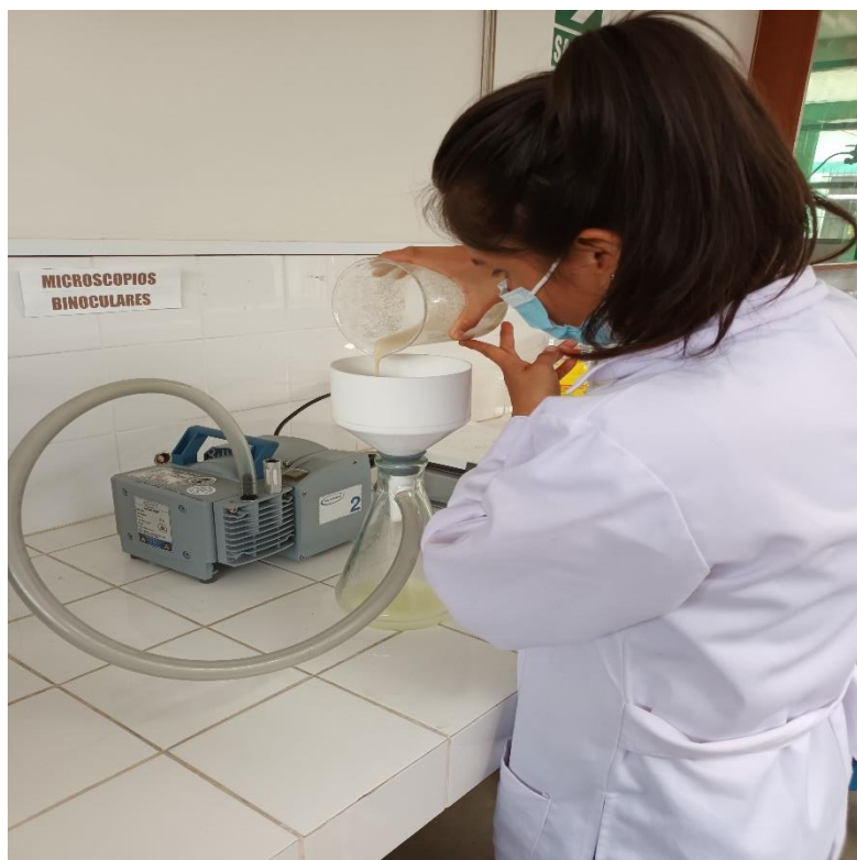
Fotografía 12. Extracción de aceites y grasas del polvo por filtrado a vacío
