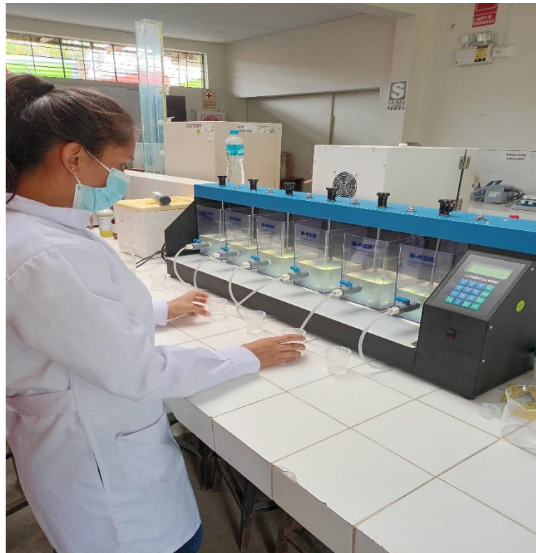
Fotografía 15. Tratamiento mediante prueba de jarras
