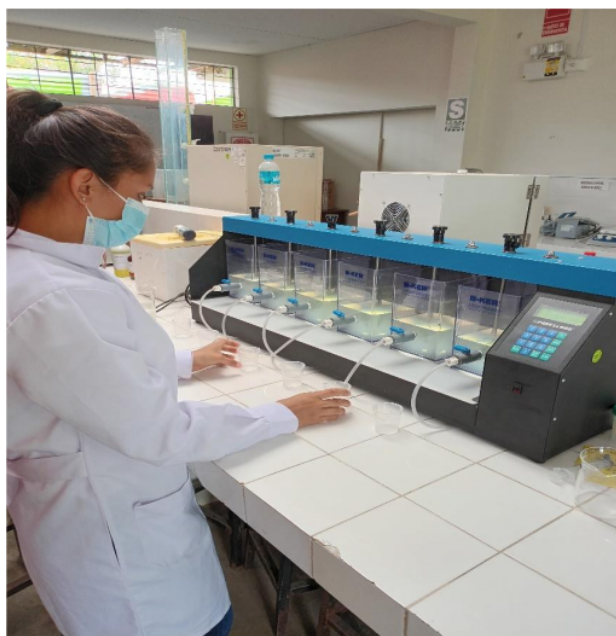
Fotografía 15. Tratamiento mediante prueba de jarras
