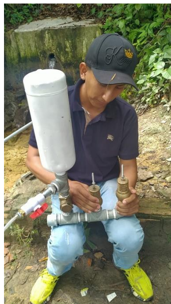
Fotografía N° 02: La implementación de la bomba de ariete.
