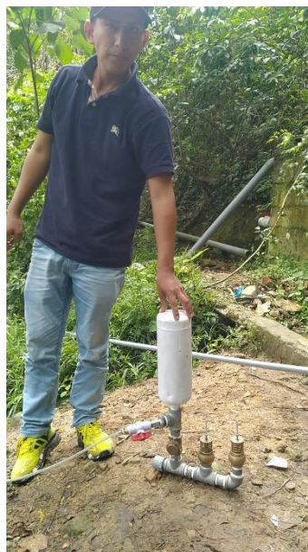
Fotografía N° 04: Bomba de ariete terminada.
