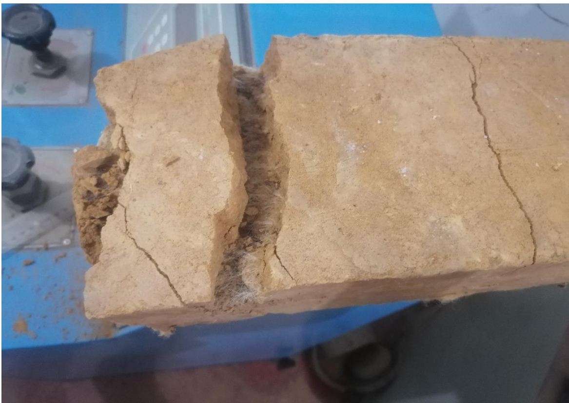
Figura 24. Evaluación de material de estudio – rotura de los bloques con 25 g.
