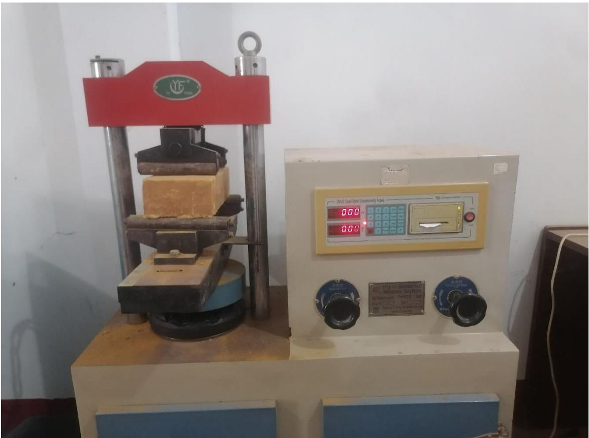
Figura 23. Evaluación de material de estudio – rotura de los bloques con 10 g.
