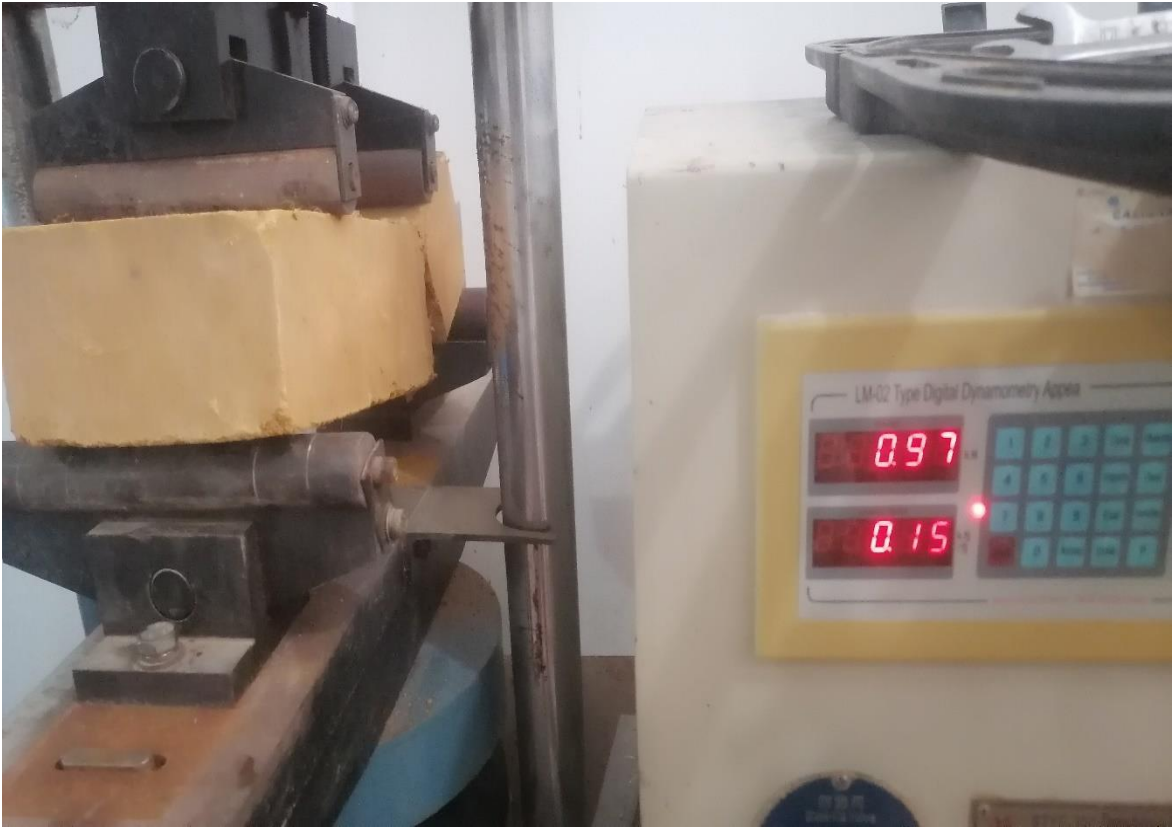
Figura 22. Evaluación de material de estudio – rotura de los bloques con 0 g.
