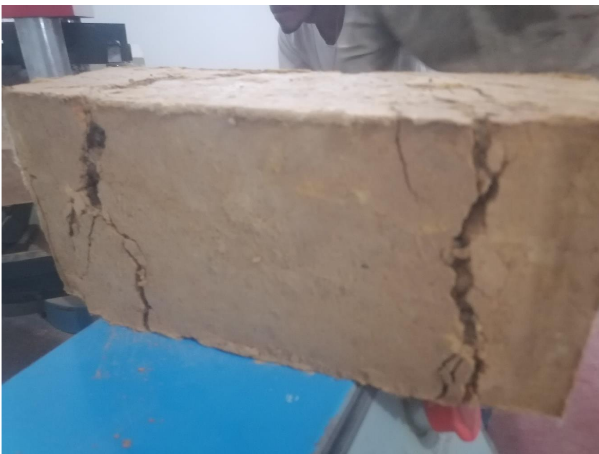
Figura 25. Evaluación de material de estudio – rotura de los bloques con 40 g.
