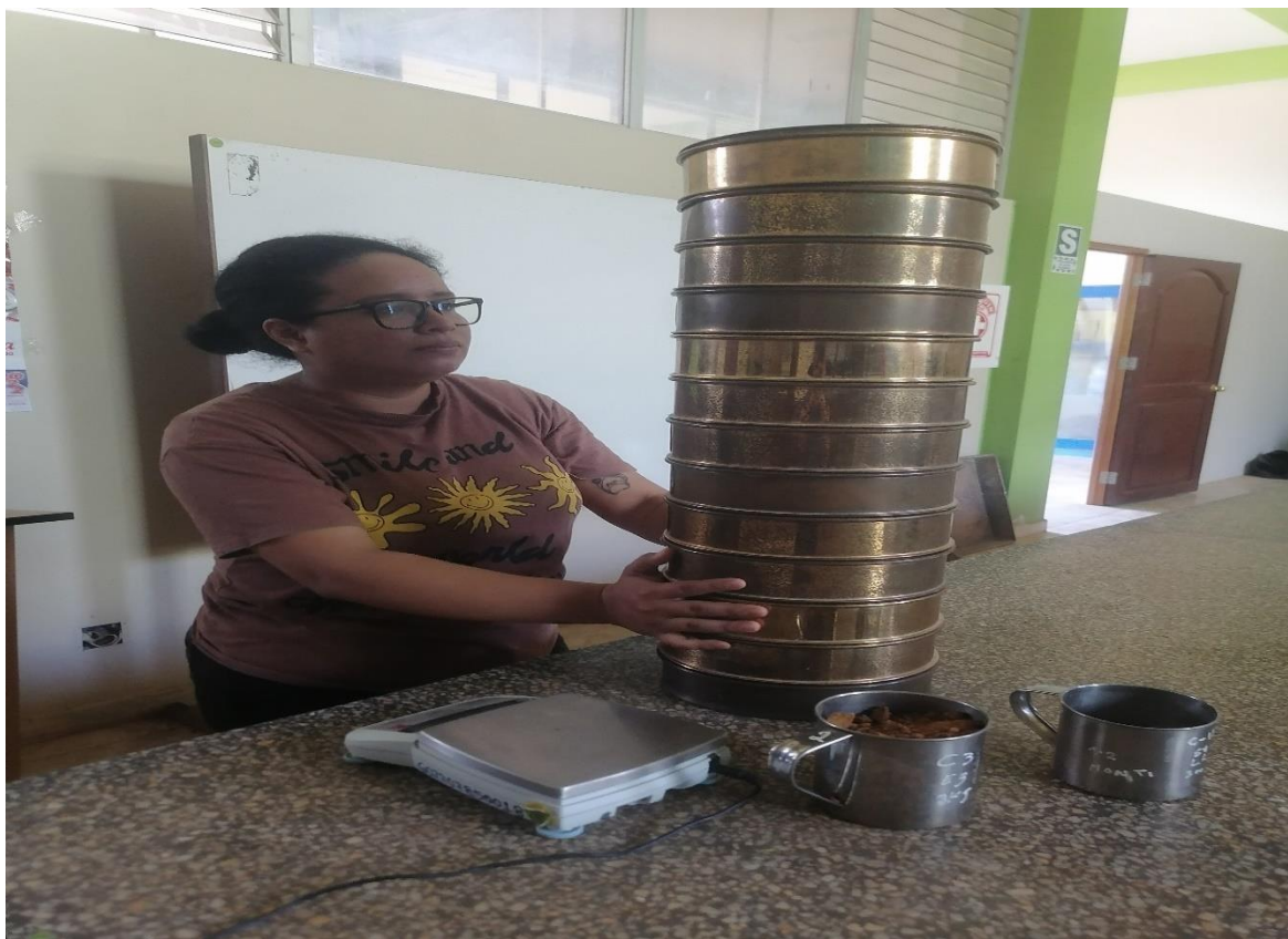
Figura 18. Evaluación de material de estudio – granulometría.
