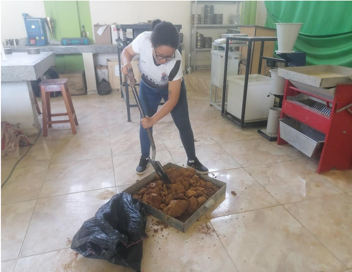
Figura 20. Evaluación de material de estudio – mezcla para los adobes.
