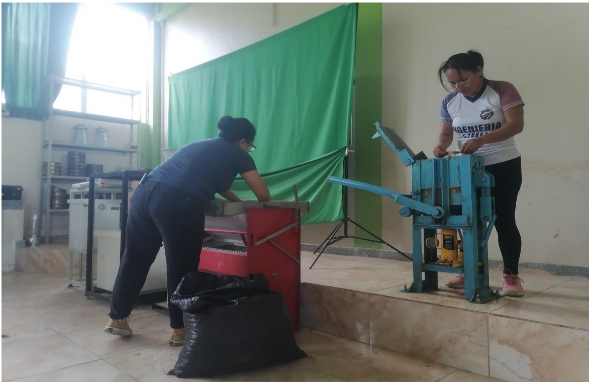
Figura 21. Evaluación de material de estudio – moldeado de los adobes.
