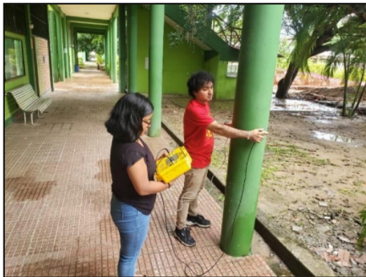
Foto N° 22: Realizando el ensayo de ultrasonido con el equipo electrónico en las columnas del Pabellón de Laboratorios y Gabinetes de la Facultad de Ciencias Agrarias (Fuente: Elaboración propia)
