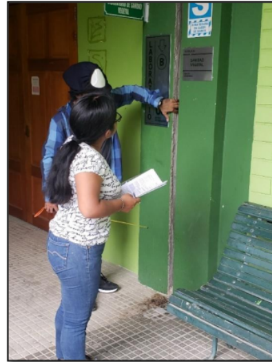
Foto N° 06: Toma de datos Insitu para realizar la evaluación por el método de Hirosawa del primer nivel del Pabellón de Laboratorios y Gabinetes de la Facultad de Ciencias Agrarias (Fuente: Elaboración propia)
