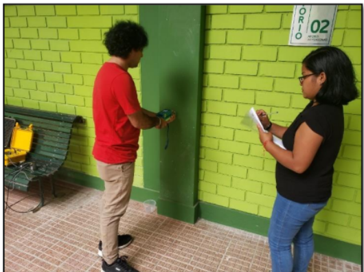
Foto N° 18: Realizando el ensayo de esclerometría con el equipo electrónico en las columnas del Pabellón de Laboratorios y Gabinetes de la Facultad de Ciencias Agrarias (Fuente: Elaboración propia)
