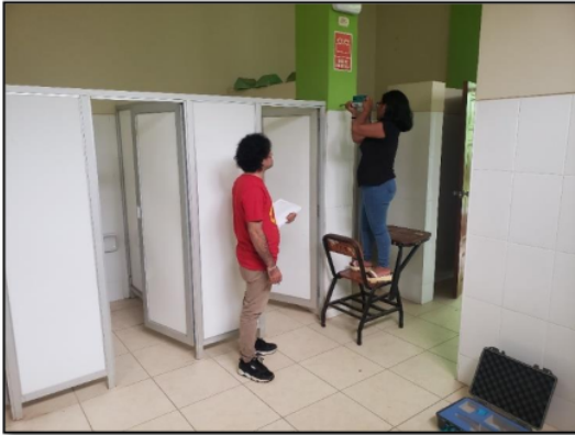
Foto N° 20: Realizando el ensayo de esclerometría con el equipo electrónico en las columnas del Pabellón de SS-HH de la Facultad de Ingeniería Agroindustrial (Fuente: Elaboración propia)
