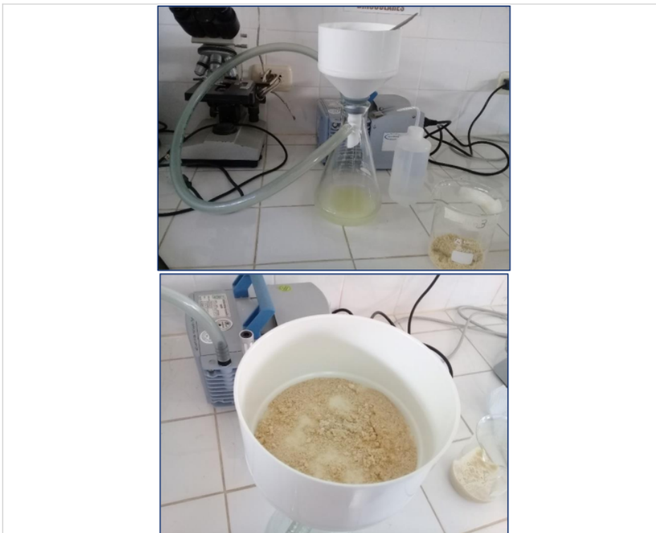
Fotografía 6. Filtrado al vacío para la separación del polvo de Moringa oleifera de los líquidos que contienen las grasas.
