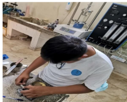
Foto N° 4 Observamos el procedimiento de la muestra del ensayo para el límite líquido en la copa de Casagrande.
