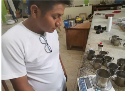
Foto N°1. Pesado de la muestra del suelo luego del secado en el horno
