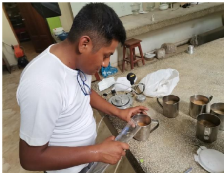
Foto N° 3 Se observa el lavado del suelo antes de cambiar la muestra a un fluido viscoso
