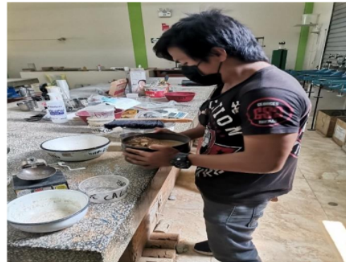
Foto N°2 Se realiza el proceso del pesado de los diferentes tamices de los suelos retenidos para el ensayo granulométrico
