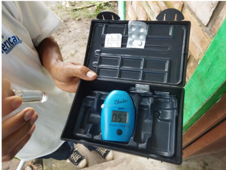
Fotografía 8. Resultado de muestra de cloro residual en PM-12
