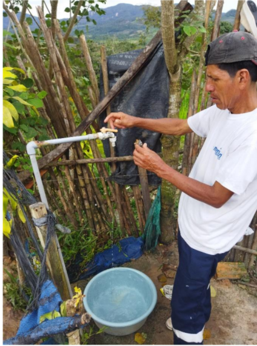
Fotografía 9. Toma de muestra de cloro residual en el PM-3
