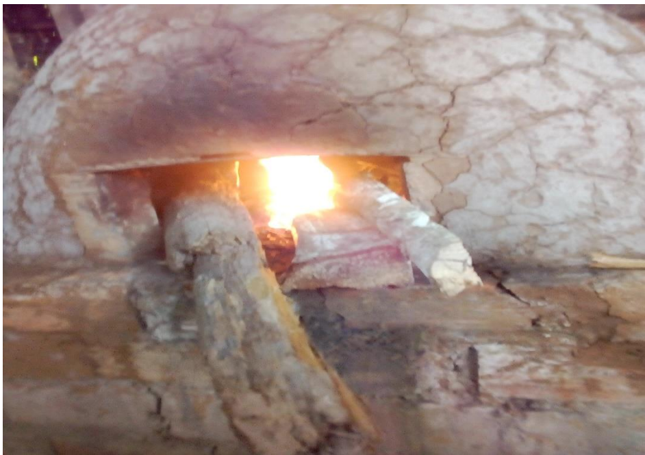
Fotografía 2: Proceso de quemado del horno artesanal
