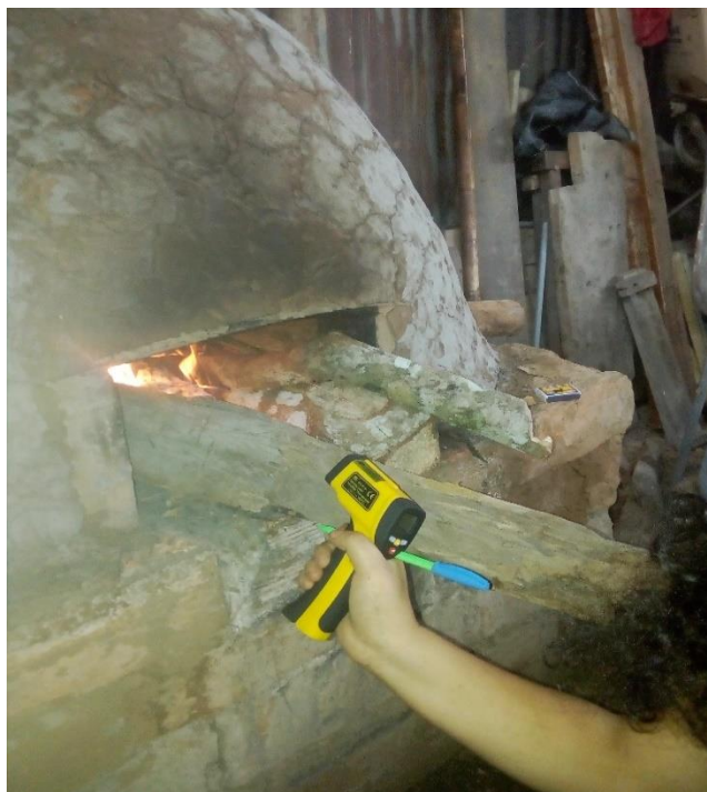
Fotografía 3. Toma de datos con el pirómetro.
