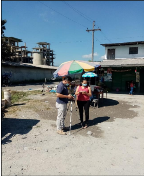
Medición de niveles de ruido
