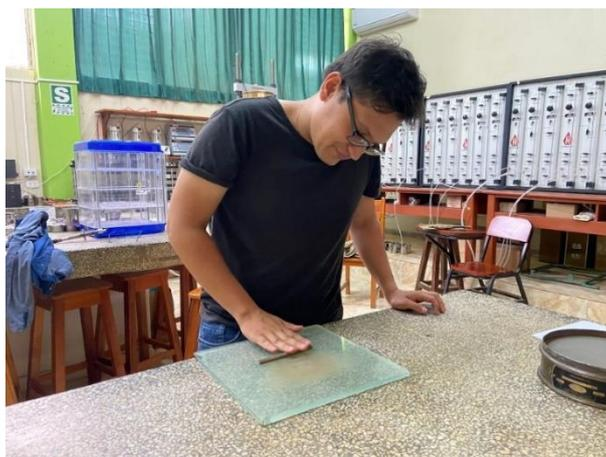
**Foto 9:** Proceso de ensayo para límite plástico
