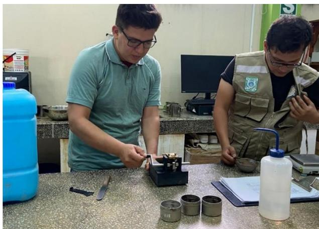
**Foto 8:** Proceso de ensayo para límite líquido
