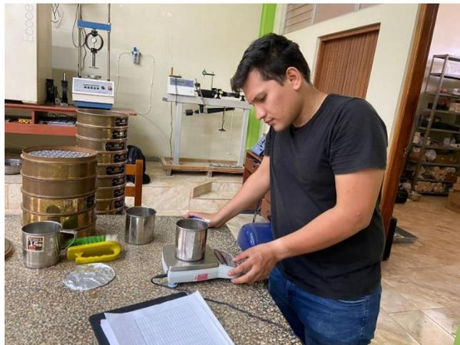
**Foto 5:** Se toma datos de la muestra extraída del horno
