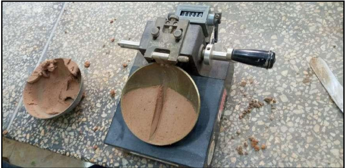
Figura 229. En la imagen se aprecia el ensayo de límites de Atterberg, para determinar el contenido de agua (Fuente: Elaboración propia)
