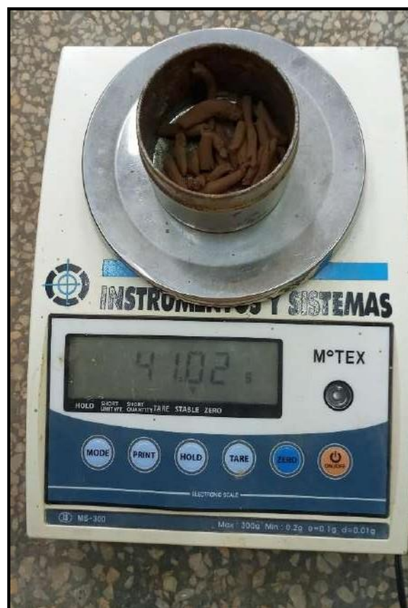
Figura 230. En la imagen se aprecia el peso de la muestra de suelo para determinar límite plástico (Fuente: Elaboración Propia)
