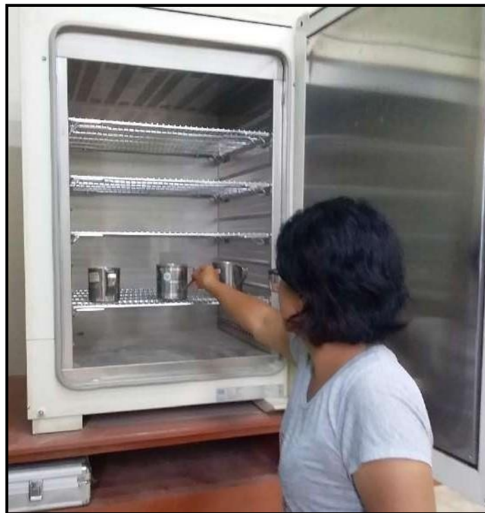
Figura 226. En la imagen se aprecia el secado de las muestras (Fuente: Elaboración Propia)
