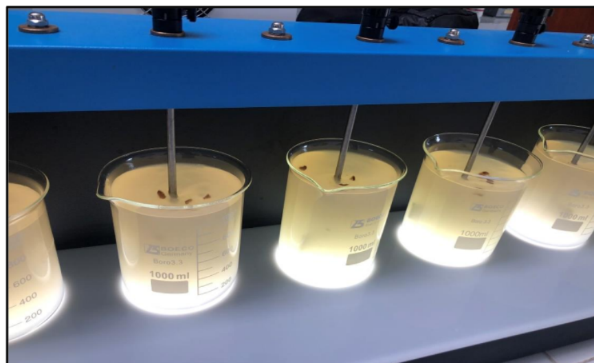
Fotografía 29. Proceso de agitación con una mezcla rápida de 150 rpm por 5 min, y una mezcla lenta de 35 rpm por 15 min y sedimentación por 15 min
